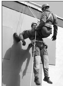
Exempel: Evakuering med Milan-nedfirningsutrustning.
