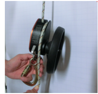
4) 将绳索向下拉然后将其推入壳体中的绳夹里
